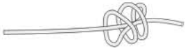
nœud M de Franciscain M heaving line knot nudo M de guía F Wurfliinienknoten M nodo M parlato doppio
